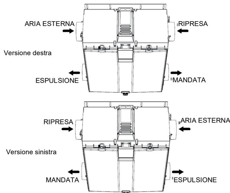
La configurazione destra/sinistra avviene in fase di avviamento tramite lo schermo LCD, senza ulteriori modifiche sull'unità. L'impostazione di fabbrica è in versione destra.
